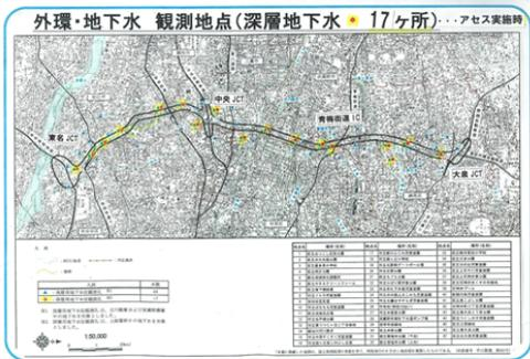
左図はアセス実施時の深層地下水の観測地点である。東名 JCT から大泉 JCT 迄 16km の間に 合計 17 点である。(アセス実施後には増やしたようであるが...) アセスでは 外環の地下水予測を行うのに 解析領域として 南北に 20km、東西に 6km の範囲としている。(ほど 左図の範囲がそれに相当)
